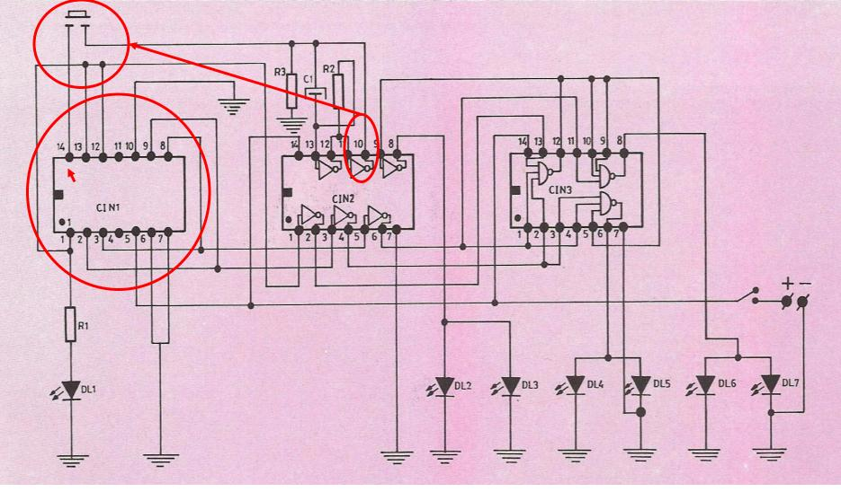
La señal del oscilador se obtiene en la patilla 10 de CIN2 y se lleva a la entrada de CIN1 del tipo 7490 situada en la patilla 14, a través del pulsador que se emplea para realizar la "tirada". Por lo tanto el efecto que se consigue es hacer pasar la señal por él y así poner en marcha la acción de contar impulsos.
