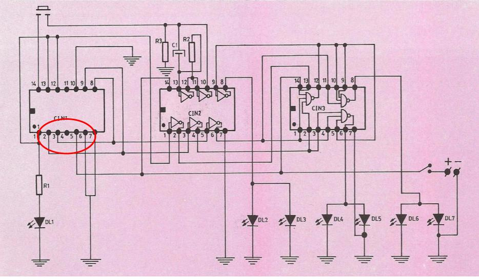
Este circuito integrado contador decádico CIN1 permite realizar una preprogramación dependiendo de las señales que se conecte a las entradas 2-3 y 5-6. Las primeras hacen que la cuenta vuelva a cero sin completar el total de 10 y las segundas realizan la misma función llevando el resultado a la cifra 9.
