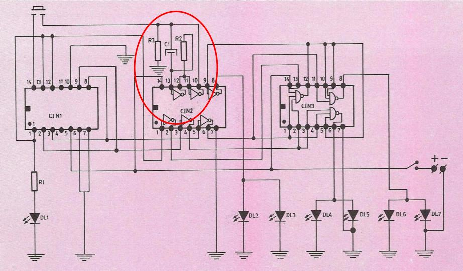
El circuito contiene un oscilador astable formado por R2, R3, C1 y los dos inversores situados entre las patillas 10-11 y 12-13 del circuito integrado CIN2 del tipo 7404. Este oscilador genera la señal que se va a emplear para que los otros circuitos realicen una "cuenta" de un cierto número de ciclos, comprendido entre uno y seis.
